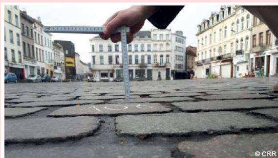
**Pavés porphyres sciés présentant une surface identique mais un confort différent (place de Moleenbeek ci-dessus : joints creusés de +/- 54 mm, confort = 5,6/10. Ci-dessous : joints creusés de +/- 1 mm, confort = 7,5/10.)**
